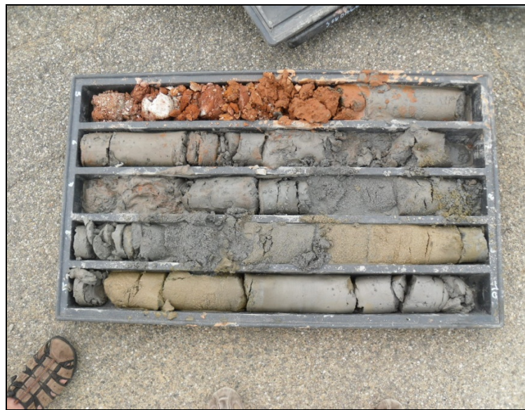
Fig.16: cassetta carotaggio tra -5 m e -10 m
